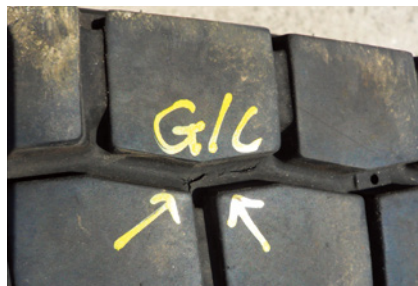
Groove Crack type 2
